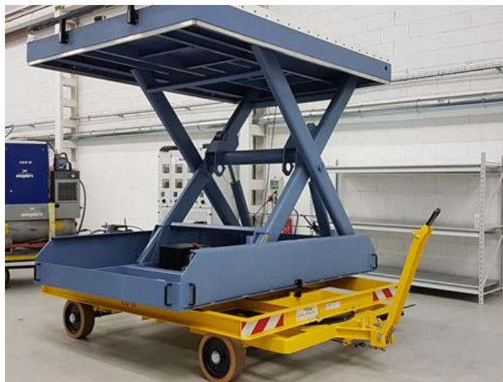
Remorque spéciale avec table élévatrice, 5 tonnes, pour le CEA
